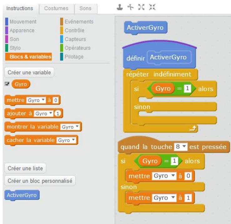
Pour résoudre le problème on va créer un sous programme (bloc) capable de travailler en tâche de fond (sans bloquer les autres programmes) et une variable Gyro qui nous permettra d'allumer ou pas les Dels.
