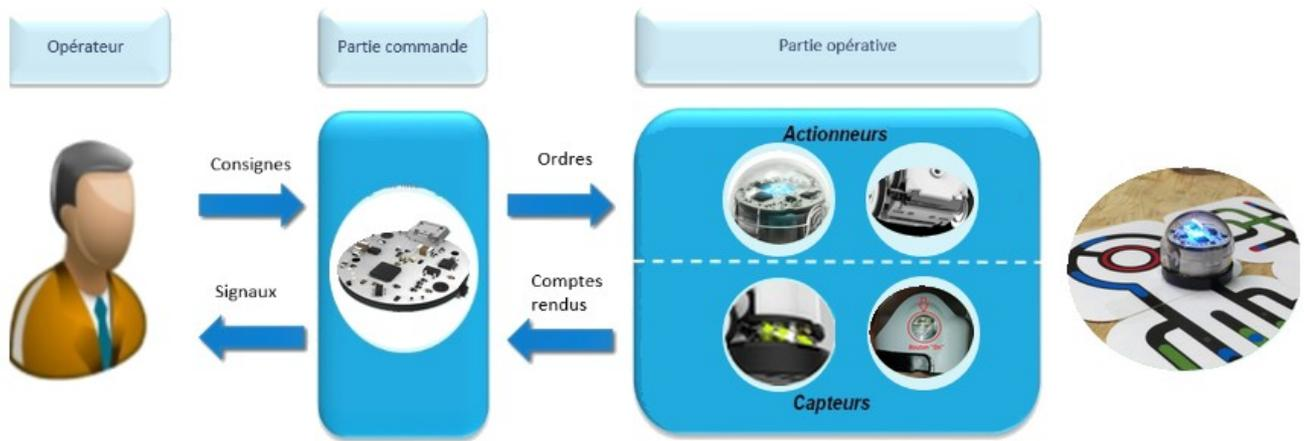
**Schéma de principe de fonctionnement**
