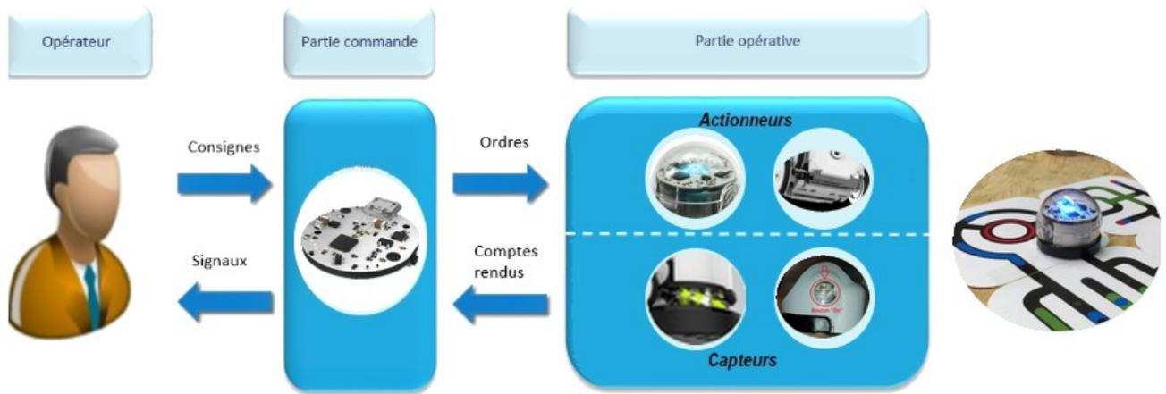
**Schéma de principe de fonctionnement**
