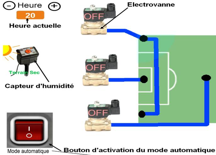
Les électrovannes peuvent être pilotées manuellement (en cliquant dessus)
